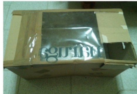
Scatola in cartone con inserimento braccio e luce interna per smerigliatura su piastrelle, mobili, ecc. evitando polvere nell'aria.
